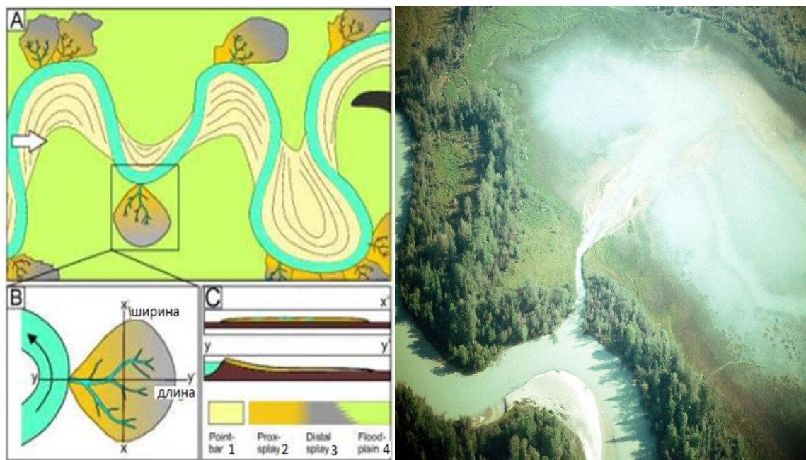
Рисунок 5 – Схематическое изображение типичных конусов прорыва берегового вала. (А) Флювиальная система с конусами прорыва. (В) Размер конуса. (С) Разрез конуса: 1 – прирусловая отмель; 2 – ближний пойменный конус; 3 – дальний пойменный конус; 4 – пойма
